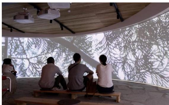
半円状の窓ガラス内側上部に設置されたレールに沿って、幅 1メートルの湾曲した白いボードを複数並べることで、1枚の格納型大型スクリーンを実現しました。ボードとボードの接地部分には隙間が見えないようにする工夫が施されているので、違和感のないパノラミックな視聴空間を創出します。
